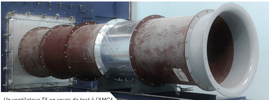
Un ventilateur TA en cours de test à l'AMCA
