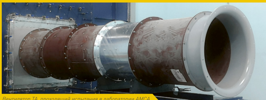
Вентилятор TA, проходящий испытания в лаборатории AMCA
