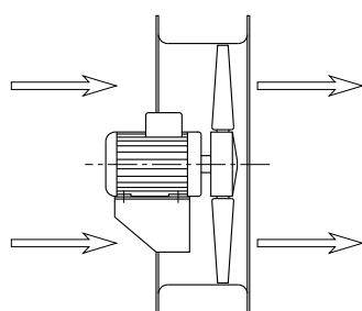
Flusso da MOTORE a GIRANTE (Orientamento standard)
