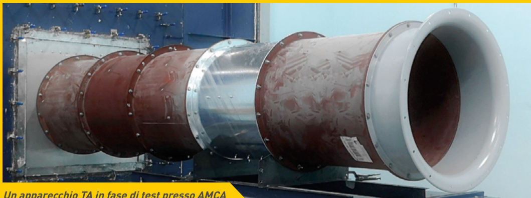
Un apparecchio TA in fase di test presso AMCA A TA fan being tested in AMCA
