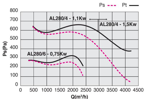
Le prestazioni aeronautiche sono rilevate in conformità alla norma EN ISO 5801/AMCA 210 con densità dell'aria standard avente peso specifico 1,2 Kg/m<sup>3</sup>.
