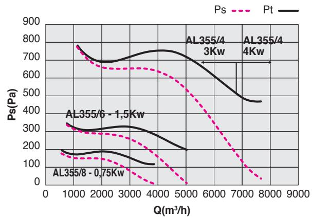
Le prestazioni aeronautiche sono rilevate in conformità alla norma EN ISO 5801/AMCA 210 con densità dell'aria standard avente peso specifico 1,2 Kg/m<sup>3</sup>.
