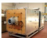
Camera di prova automatizzata per test aerulici di ventilatori domestici, conforme alla norma statunitense AMCA 210 e alla norma internazionale ISO 5801. L'apparecchiatura è fondamentale per misurare le prestazioni degli apparecchi e la loro efficienza massima, parametro sempre più critico in uno scenario di risparmio energetico.
