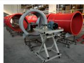
Sistema automatizzato per test aerulici di ventilatori industriali di diametri compresi tra 450 e 630 mm e tra 700 e 1000 mm, conforme alla norma statunitense AMCA 210 e alla norma internazionale ISO 5801.
