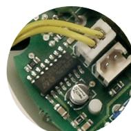
Versione HT con circuito elettronico a microprocessore
