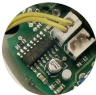
Versione HT con circuito elettronico a microprocessore
