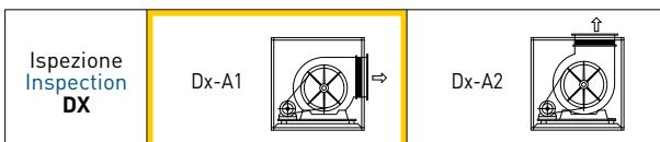
N.B.: Orientamento standard DX-A1 | Standard discharge DX-A1
