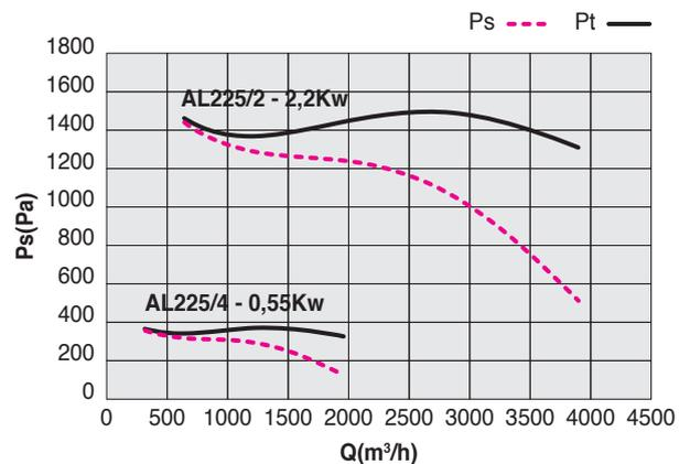
Le prestazioni aerauliche sono rilevate in conformità alla norma EN ISO 5801/AMCA 210 con densità dell'aria standard avente peso specifico 1,2 kg/m<sup>3</sup>. Alimentazione 400V/3Ph/50Hz.
