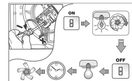
Agire sul trimmer (vite) di regolazione mostrato in figura per aumentare o ridurre il ritardo di spegnimento dell'apparecchio (da 3 a 25 minuti).
